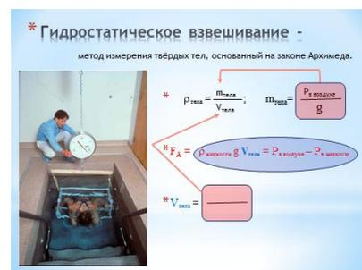
Выведите формулу для определения плотности твердого тела способом гидростатического взвешивания, пользуясь предложенной схемой.
